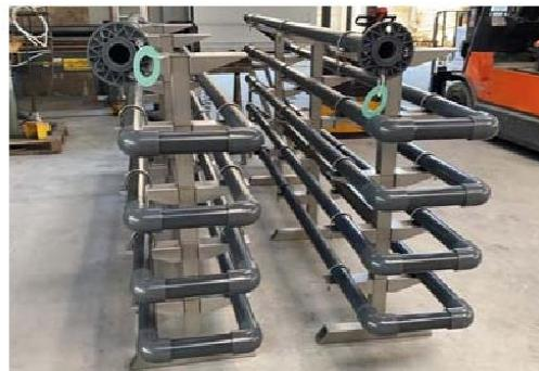
Flokulacija mulja može se izvršiti i pomoću statičke flokulacione cevi napravljene od PVC-a dovoljne dužine da bi vreme za koje tečnost prođe kroz cev bilo dovoljno da se izvrši proces flokulacije.
