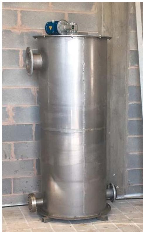
Dinamički flokulator X-AF je cilindrični rezervoar za mešanje čiji je koncentracija mešanja mulja sa razblaženim polielektrolitom maksimalno od 5%-6%.
